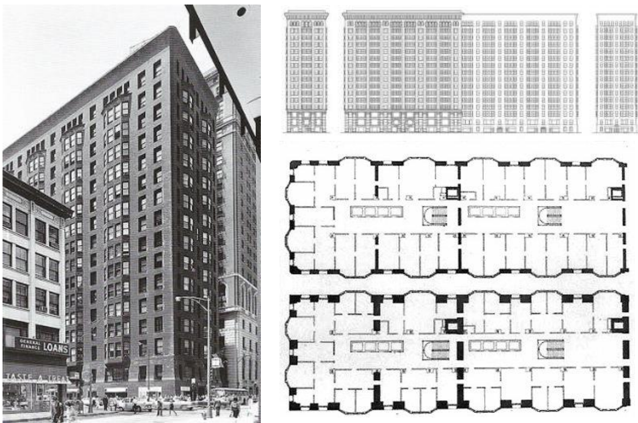
Рис. 1.4. Американська офісна будівля кінця XIX століття Монаднок білдінг / Monadnock building, Чикаго (Іллінойс), 1889-1893, проєкт фірм Burnham & Root (арх. Голабірл Рут, Джон Велборн Бернем, Деніел Хадсон) (від 1889 р.) і Holabird & Roche (від 1893 р.): загальний вигляд, фасади та плани поверхів
